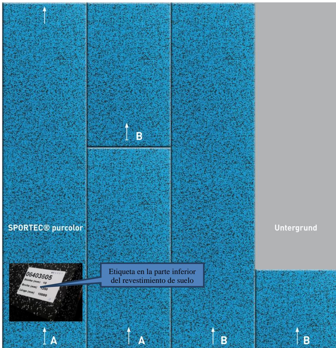
**Figura 5:** Colocación de los rollos en la misma dirección
